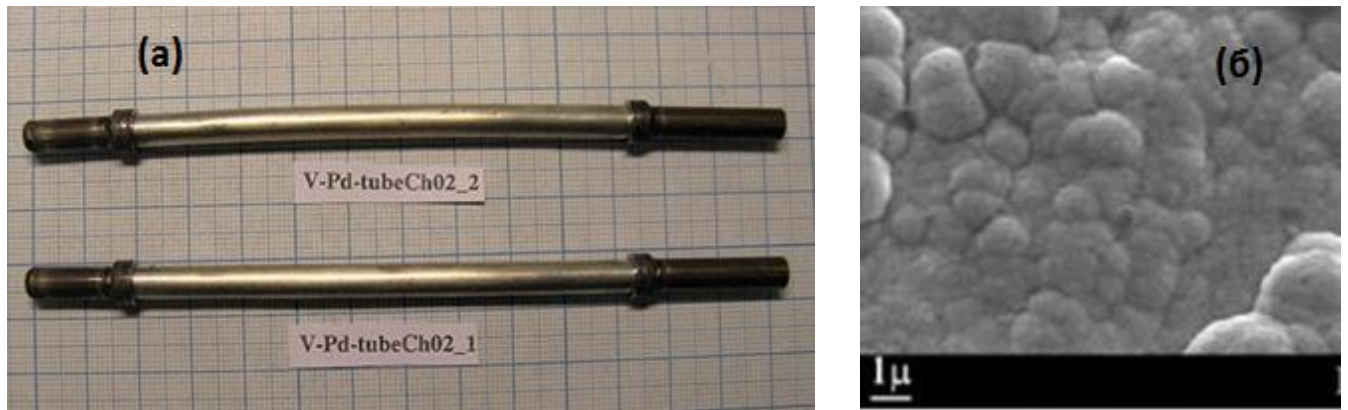
Рисунок 2.9 - Фотография трубчатых мембран до проведения эксперимента по термостабильности палладиевого покрытия (а), фотография электронной микроскопии химически осажденного покрытия (б).
